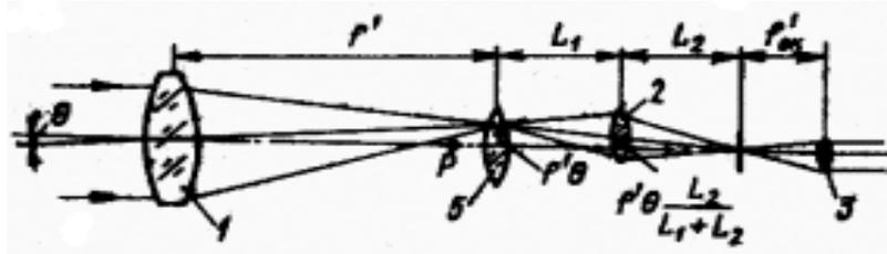
А) оборачивающая система; Б) компенсатор; В) коллектив; Г) окуляр.
