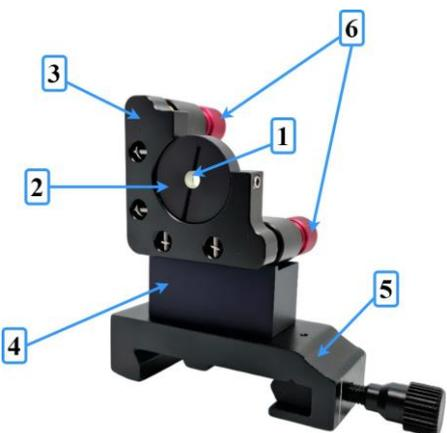
Плоскопараллельный активный элемент (1) из кристалла  $Y_3Al_5O_{12} : Nd$  имеет длину и диаметр 5 мм. На торцы активного элемента нанесено просветляющее покрытие на длине волны 1064 нм. Концентрация ионов  $Nd^{3+}$  составляет 1 ат.%. Активный элемент расположен в сменном держателе (2), который крепится в регулируемый кинематический держатель (3). Последний через установочную проставку (4) крепится к каретке (5). Винты (6) позволяют регулировать положение зеркала резонатора по углу наклона.
