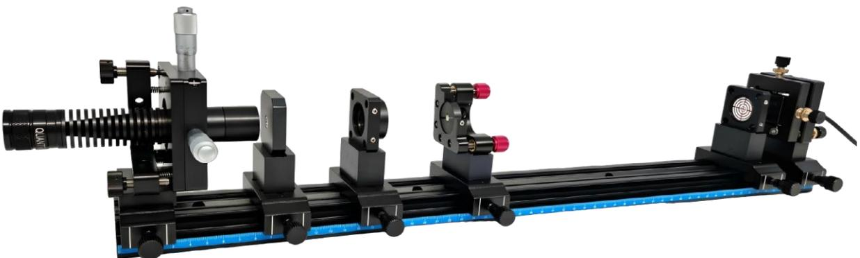
Рис. 17: Настройка положения активного элемента из кристалла YAG:Nd.
