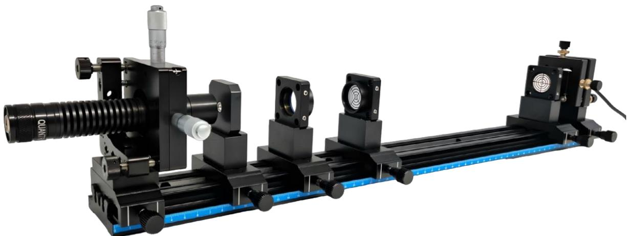
Рис. 9: Настройка положения фокусирующего объектива.
