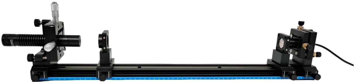
Рис. 7: Установка оптической оси твердотельного лазера YAG:Nd с помощью юстировочного лазера видимого спектрального диапазона.
