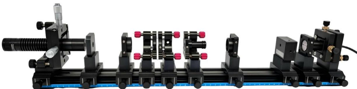
Рис. 15: Измерение интенсивности излучения лазера на кристалле YAG:Nd.
