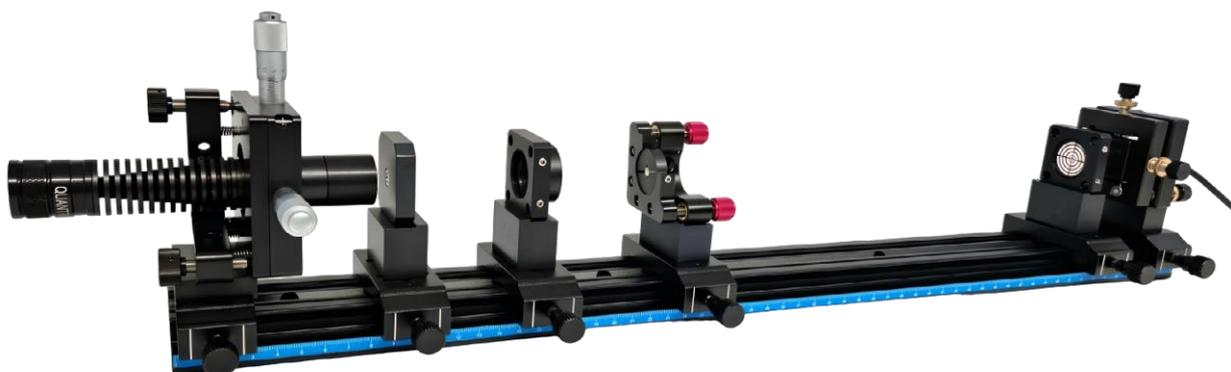
Рис. 11: Настройка положения активного элемента из кристалла YAG:Nd.
