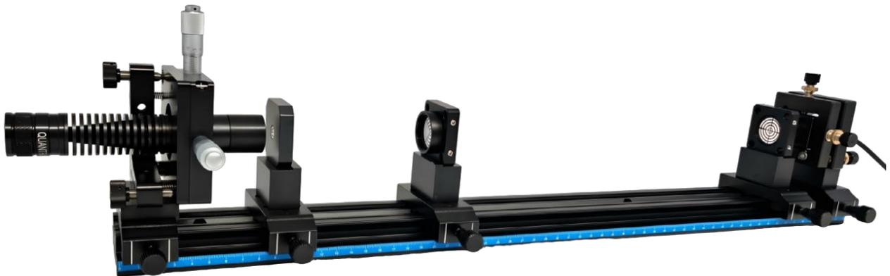
Рис. 8: Настройка траектории лазерного луча накачки твердотельного лазера YAG:Nd.
