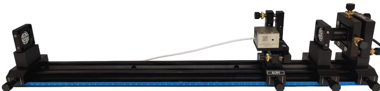
Рис. 6: Настройка положения акустооптического модулятора.
