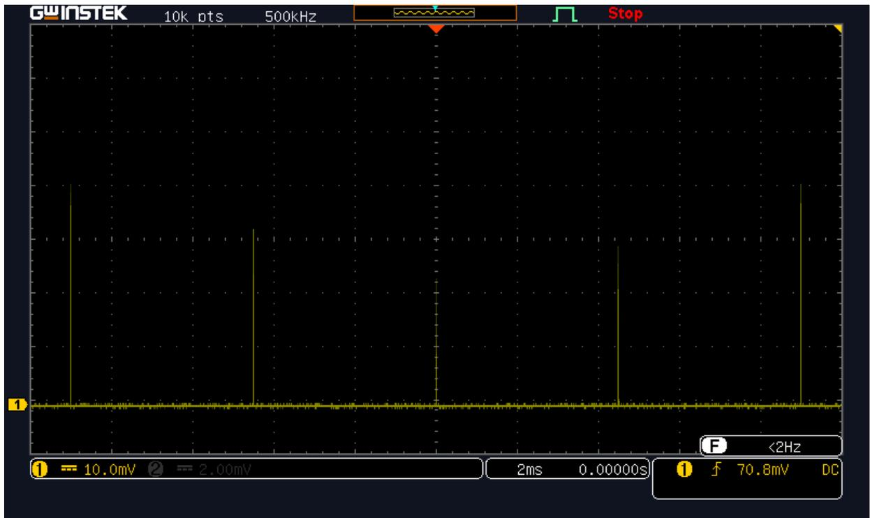
Рис. 18: Осциллограмма импульсного режима работы YAG:Nd лазера.
