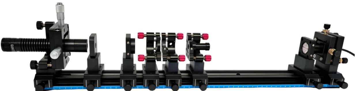
Рис. 19: Настройка положения выходного зеркала резонатора.
