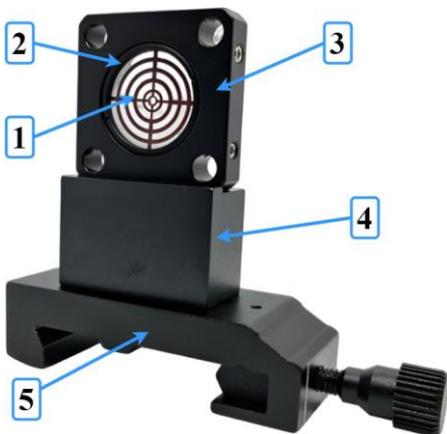
Диафрагма необходима для выставления оптической оси лабораторной установки. Диаметр диафрагмы составляет 25 мм. Она имеет центральное сквозное отверстие диаметром 2 мм.
