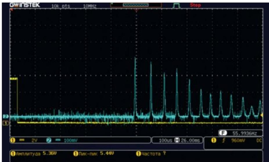
Рис. 22: Осциллограмма пикового режима работы YAG:Nd лазера.
