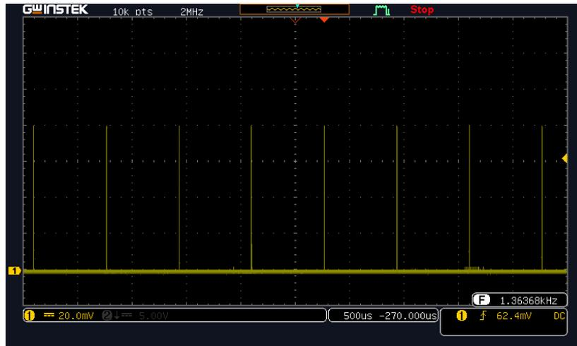
Рис. 17: Осциллограмма импульсного режима работы YAG:Nd лазера.
