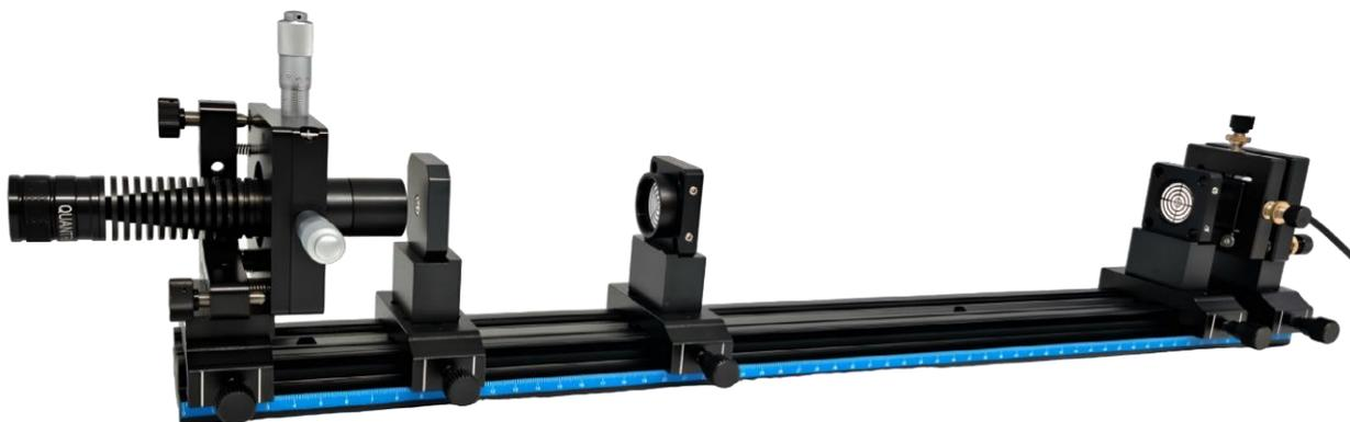
Рис. 9: Настройка траектории лазерного луча накачки твердотельного лазера YAG:Nd.
