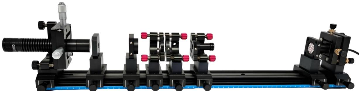
Рис. 12: Настройка положения выходного зеркала резонатора.
