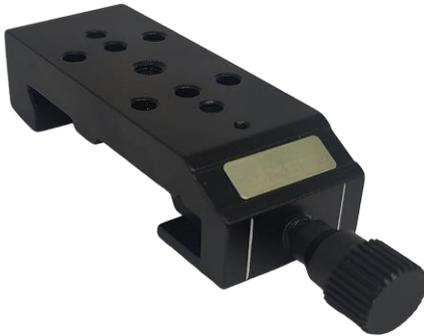
Все элементы  $Y_3Al_5O_{12} : Nd$  лазера установлены на оптические каретки, которые позволяют перемещать их с высокой точностью вдоль оптического рельса. Каретка имеет крепежные резьбовые отверстия М4 и М6 на верхней панели. Каретка фиксируется на оптическом рельсе с помощью прижимного винта.
