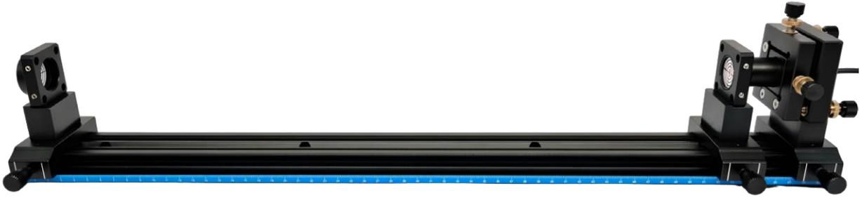
Рис. 6: Настройка оптической оси твердотельного лазера YAG:Nd с помощью юстировочного лазера видимого спектрального диапазона.
