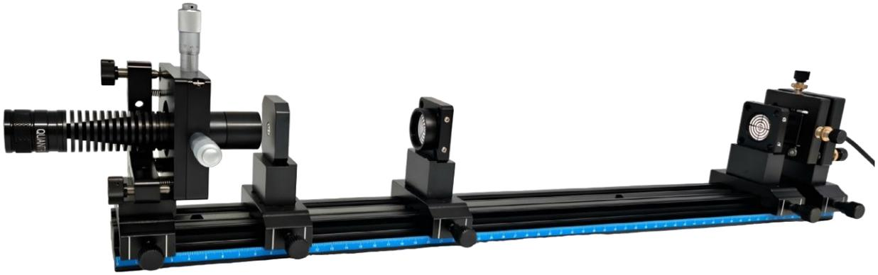
Рис. 15: Настройка траектории лазерного луча накачки твердотельного лазера YAG:Nd.
