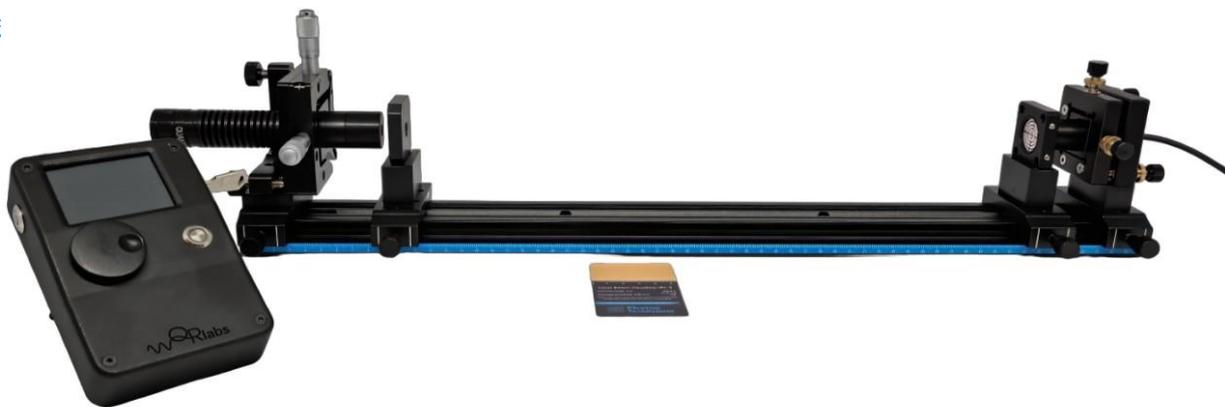
Рис. 8: Настройка положения коллиматора.
