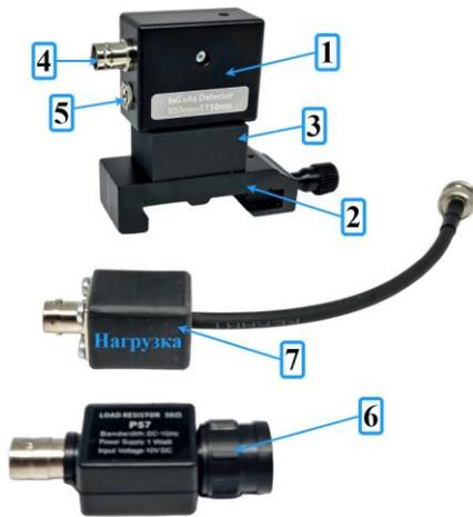
Фотодетектор на основе структуры InGaAs предназначен для детектирования интенсивности излучения накачки, генерации и люминесценции в спектральной области 800 — 1750 нм. Спектральная чувствительность фотодетектора представлена на спектре.
