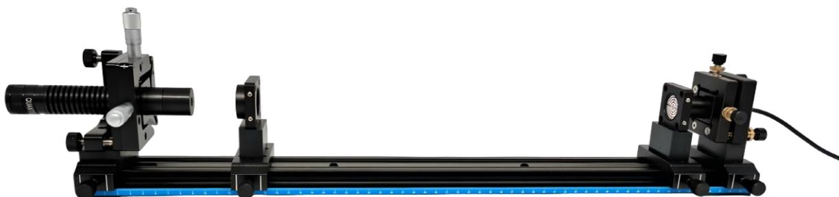
Рис. 13: Установка оптической оси твердотельного лазера YAG:Nd с помощью юстировочного лазера видимого спектрального диапазона.
