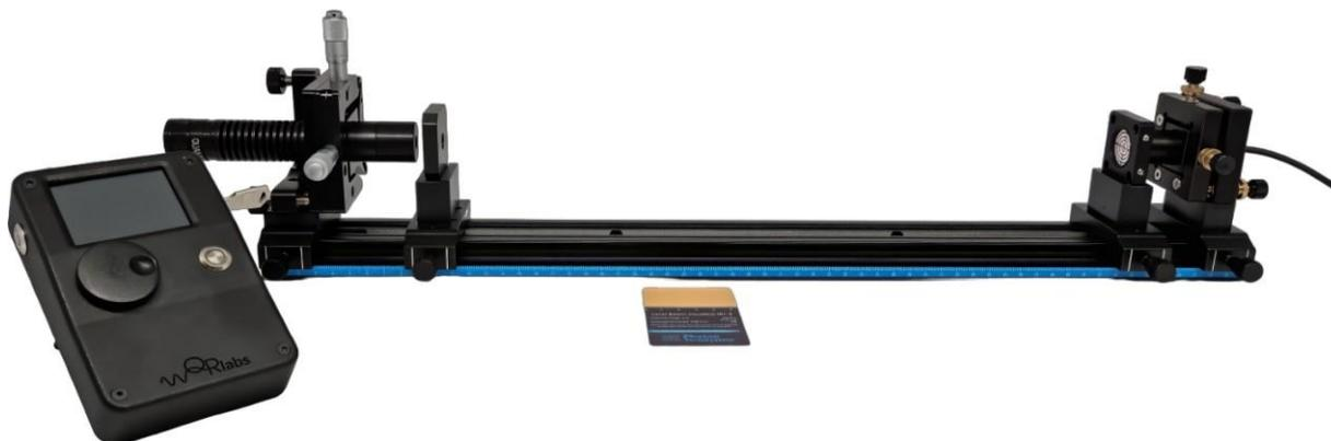
Рис. 14: Настройка положения коллиматора.
