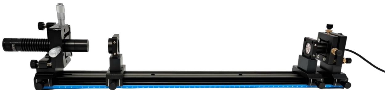
Рис. 6: Установка оптической оси твердотельного лазера YAG:Nd с помощью юстировочного лазера видимого спектрального диапазона.
