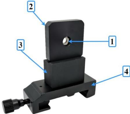
Для коллимации излучения диодного лазера накачки используется асферическая линза, закрепленная в соответствующий держатель. Фокусное расстояние линзы 13,86 мм. Торцы линзы имеют просветляющее покрытие в области 650–1100 нм. Асферическая линза (1) устанавливается в держатель (2). Последний через установочную проставку (3) крепится к каретке (4).
