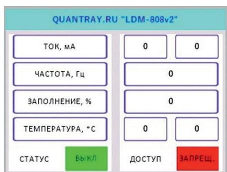
Нажмите кнопку включения питания (7) на боковой панели терминала. Вставьте ключ доступа (1) в предохранительный замок (8) и поверните на 90° по часовой стрелке. Индикатор «ДОСТУП ЗАПРЕЩ.» изменится на «ДОСТУП РАЗРЕШ.». Нажмите кнопку (5) активации излучения. «СТАТУС ВЫКЛ» изменится на «СТАТУС ВКЛ» и индикатор статуса будет мигать зеленым и красным. По окончании работ с излучением выполнить операции в обратной последовательности.
