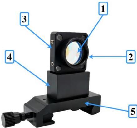
Для фокусирования излучения диодного лазера накачки в активный элемент из кристалла  $Y_3Al_5O_{12} : Nd$  используется двояковыпуклая линза (1) с фокусным расстоянием 60 мм. Линза (1) устанавливается в круглый держатель (2), который крепится в квадратный держатель (3). Последний через установочную проставку (4) устанавливается на оптическую каретку (5).
