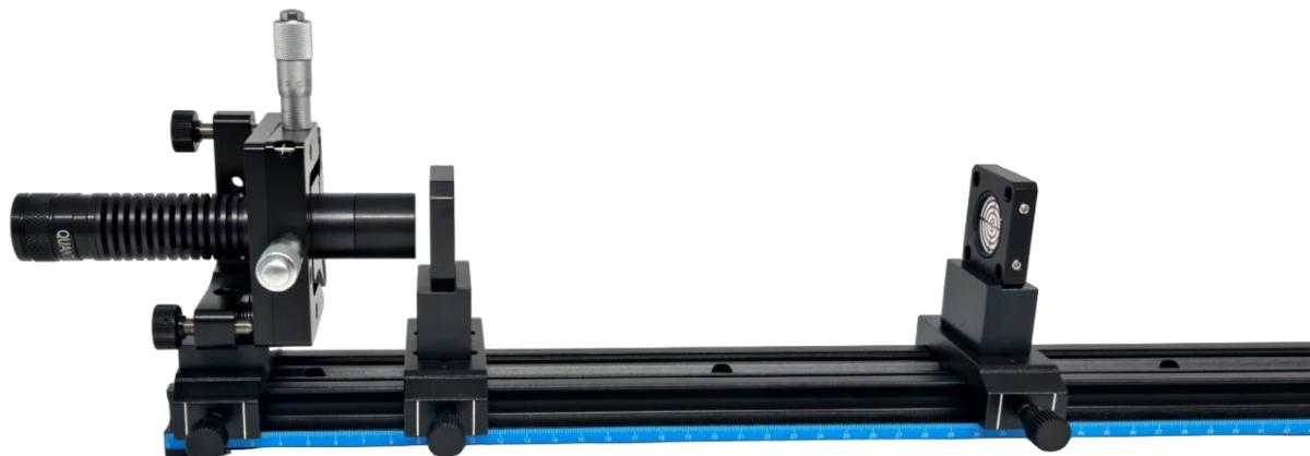
Рис. 7: Настройка положения коллиматора.
