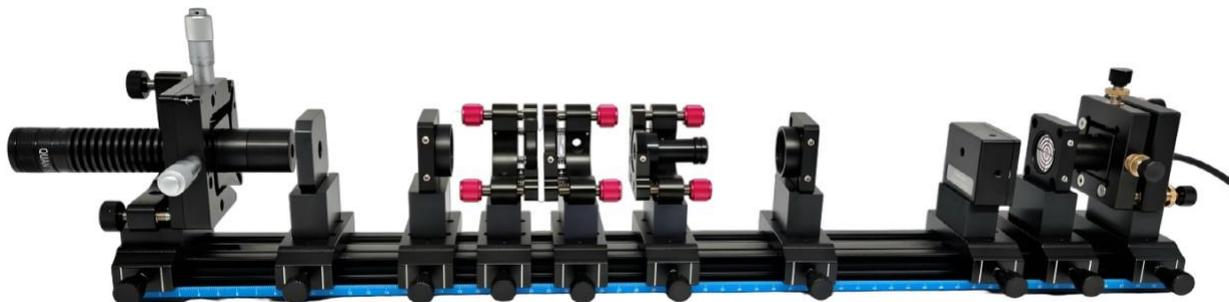
Рис. 21: Измерение интенсивности излучения лазера на кристалле YAG:Nd.
