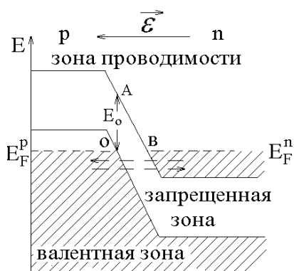
Рис.2. Зонная структура туннельного вырожденного р-п-перехода в отсутствие внешнего напряжения
