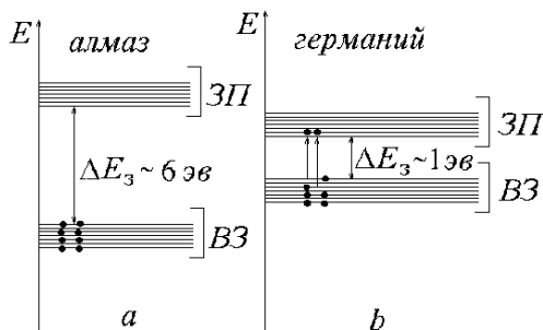
Рис.1. Зонные энергетические диаграммы: а) - непроводника; б) - полупроводника
