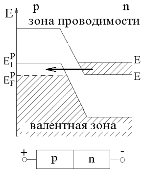
Рис.4. Зонная структура вырожденного р-п-перехода соответствующая максимуму туннельного тока
