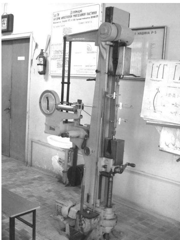
Рис. 2. Испытательные машины Р-5
