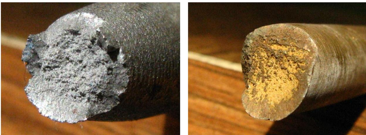
Рис. 3 Фотографии мест разрыва стального (а) и латунного (б) образцов
