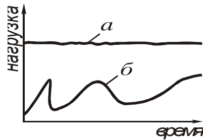
Рис. 12. Графики, показывающие изменение нагрузок во времени: a - статическая; б - динамическая
