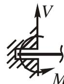
Рис. 4.4. Схематическое изображение подвижной заделки
