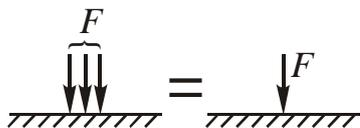
Рис. 11. Схема к определению сосредоточенной силы
