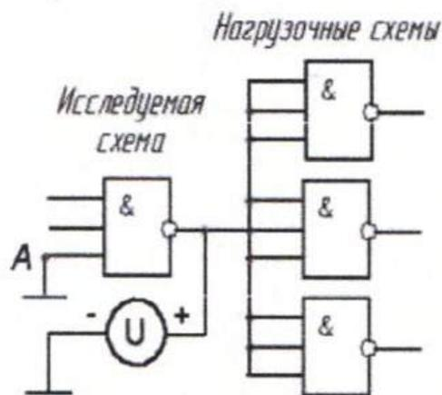
Рис.5. Схема измерения коэффициента разветвления по выходу ( $n$ ).
