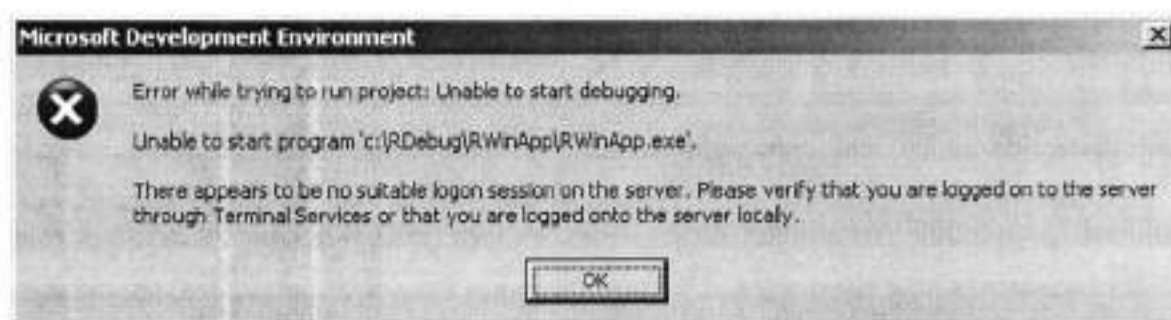
Рисунок 2. Ошибка при запуске отладчика, когда на удаленной машине выполнен вход под другой учетной записью.
