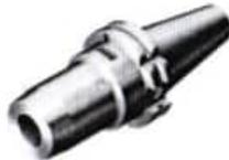
Другим вариантом зажима инструмента с цилиндрических хвостовиком является патрон с термообжимом. Отверстие в патроне немного меньше, чем диаметр хвостовика, для смены инструмента патрон нагревают индукционной катушкой, чтобы он расширился. Точность по биению очень хорошая при усилнии зажима от среднего до высокого.
