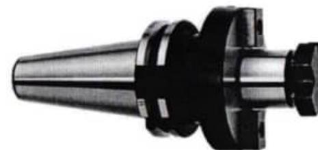
Торцевые фрезы, а также некоторые дисковые, устанавливают на оправках которые имеют короткую цилиндрическую часть. На торце оправки имеются два направляющих сухаря, который защищает фрезу от проворачивания на оправке. Затяжка фрезы производится винтом, вкручиваемым в торец оправки.
