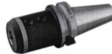
Для зажима концевых фрез и сверл с коническим хвостовиком используются специальные патроны с внутренним Конусом Морзе. Для фиксации сверл в таких патронах используется паз под лапку на торце сверла, а для фиксации фрез используется болт заворачивающийся в торец фрезы.
