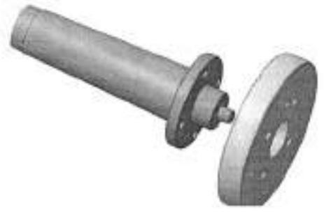
Для правильного расположения отверстий под крепежные элементы Диска и Конуса необходимо указать цилиндрические поверхности Конуса-  $\text{Ø}8\text{H}7^{(+0,015)}$  и Диска  $\text{Ø}8\text{H}7^{(+0,015)}$
