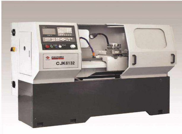
Рис. 3.1. Токарный станок с ЧПУ СJK-6132, общий вид
