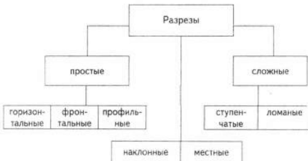
При этом часть предмета, расположенная между наблюдателем и секущей плоскостью, мысленно удаляется, а на плоскости проекций изображается то, что получается в секущей плоскости и что расположено за ней.
