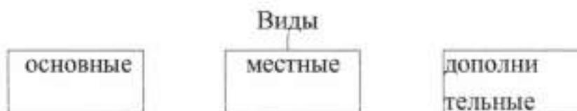
Основные виды получают при проецировании предмета на основные плоскости проекций.
