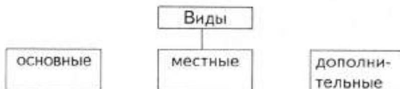
Основные виды получают при проецировании предмета на основные плоскости проекций.
