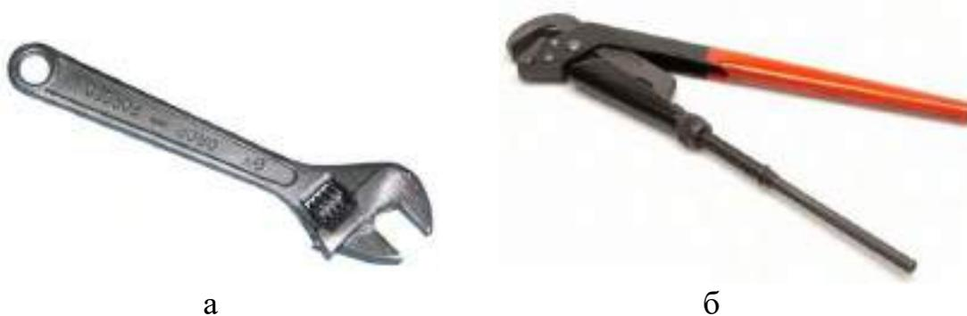
Рис. 19. Регулируемые ключи: а – разводной, б – трубный
