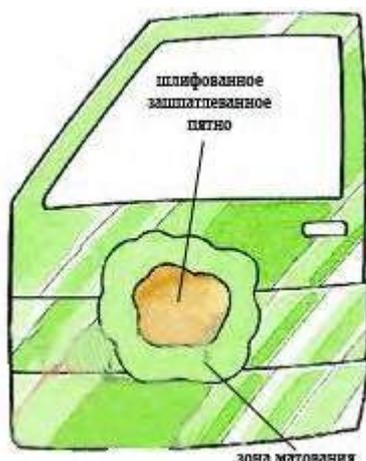
Рисунок34 – Нанесение шпатлевки на поверхность металла
