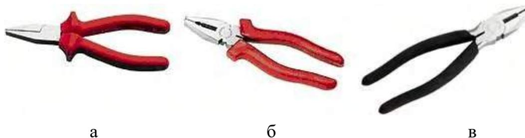
Рис. 35. Плоскогубцы: а – обычные; б – универсальные; в – электрика
