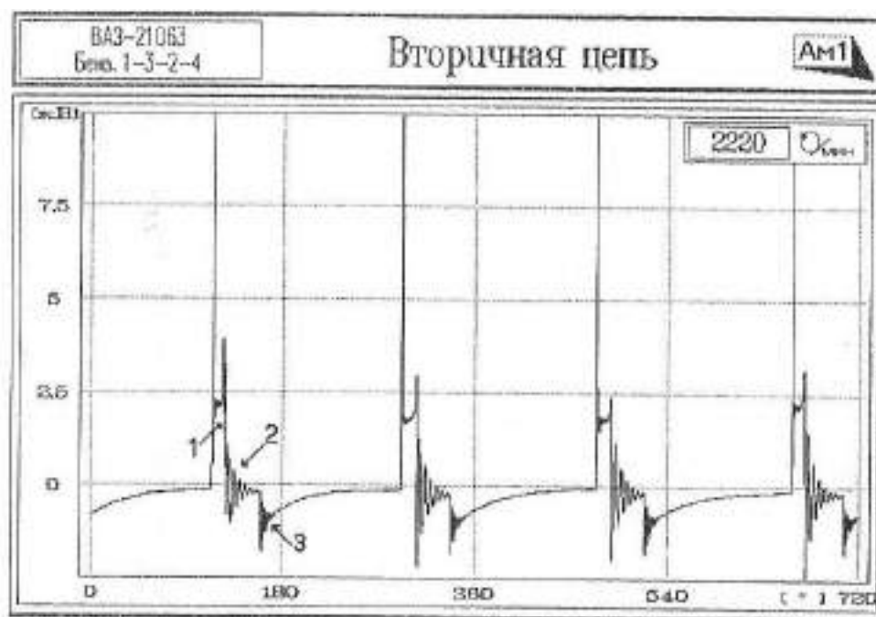
Рисунок 37. Нормальная осциллограмма вторичной цепи системы зажигания.
