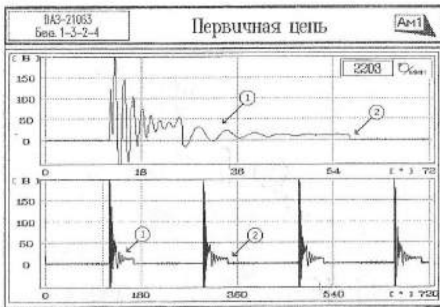
Рисунок 36. Нормальная осциллограмма первичной цепи системы зажигания.
