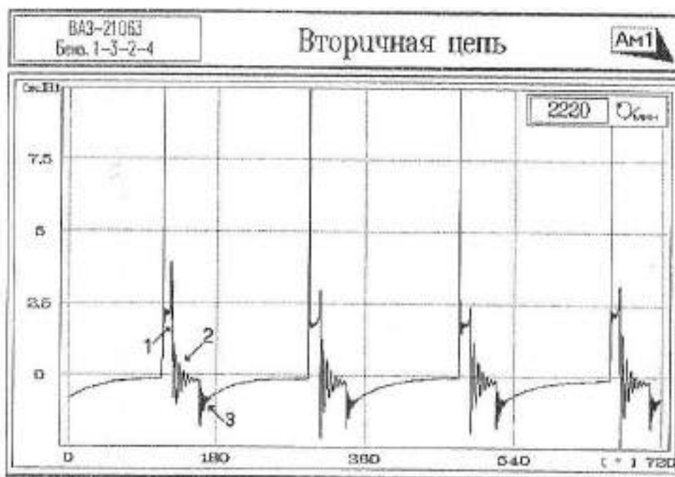
Рисунок 37. Нормальная осциллограмма вторичной цепи системы зажигания.
