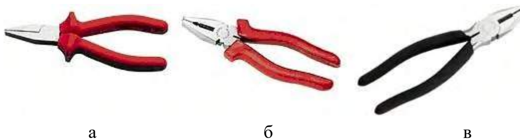
Рис. 35. Плоскогубцы: а – обычные; б – универсальные; в – электрика
