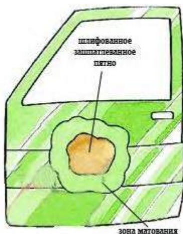
Рисунок34 – Нанесение шпатлевки на поверхность металла
