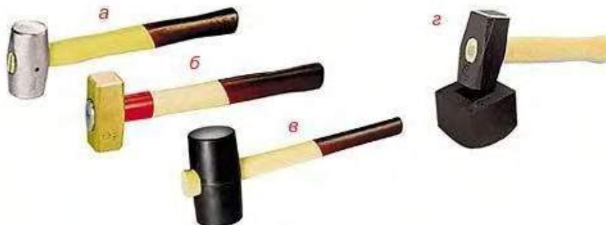
Рис. 25. Молотки из цветных металлов и резины: а – свинцовый молоток; б – медный молоток; в – резиновый молоток; г – резиновый наконечник (накостыльник) для кувалды
