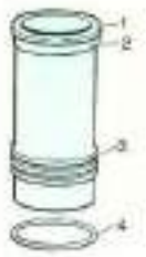
Рис. 7.1. Гильза (цилиндр) с уплотнением.
