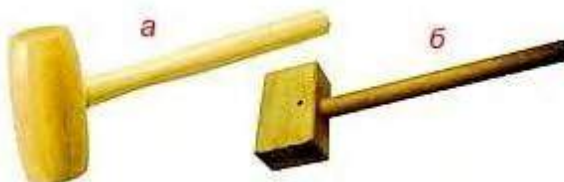
Рис. 27. Молотки из дерева (киянки) с круглой (а) и прямоугольной (б) головками
