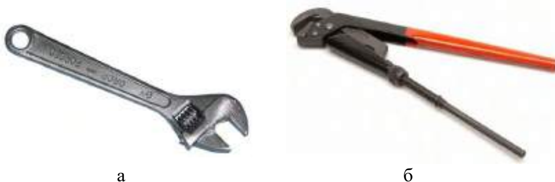
Рис. 19. Регулируемые ключи: а – разводной, б – трубный
