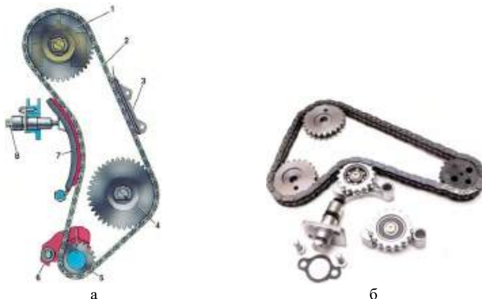
Рис. 9. Цепной привод распределительного вала: а – схема; б – внешний вид деталей; 1 – звездочка распределительного вала; 2 – цепь; 3 – успокоитель цепи; 4 – звездочка валика привода масляного насоса; 5 – звездочка коленчатого вала; 6 – ограничительный палец; 7 – башмак натяжителя; 8 – натяжитель цепи
