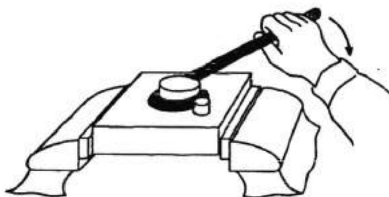
**Рис. 3.3. Приспособление для гибки кольца**
