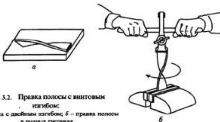
**Рис. 3.2. Правка полосы с винтовым изгибом:**
